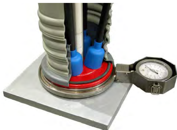
DI load cell on TTR anchorage
