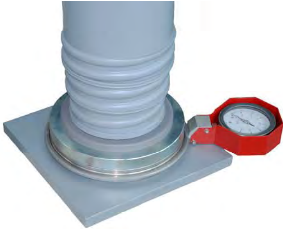
DI load cell on TTR anchorage
